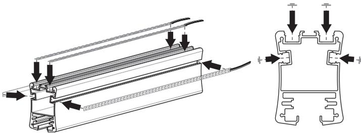
2. Appuyer et coller le ruban DEL inférieur sur le rail. Suivre les guides de 10 mm ou 14 mm.
