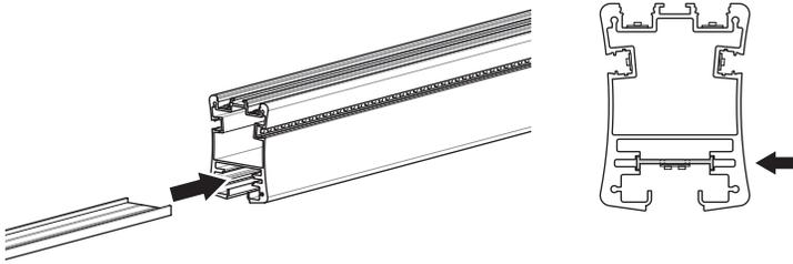
4. Mettre les lentilles en place. Si aucun ruban DEL latéral n'est pas installé, remplacer la lentilles latérales avec panneaux décoratifs (B).
